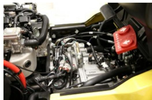
На погрузчики теперь устанавливается новый высокоэффективный двигатель Kubota объемом 2,5 литра, который совместно с уникальной системой контроля позволил существенно увеличить производительность моделей H2.0-3.5FT и S2.0-3.5FT.
